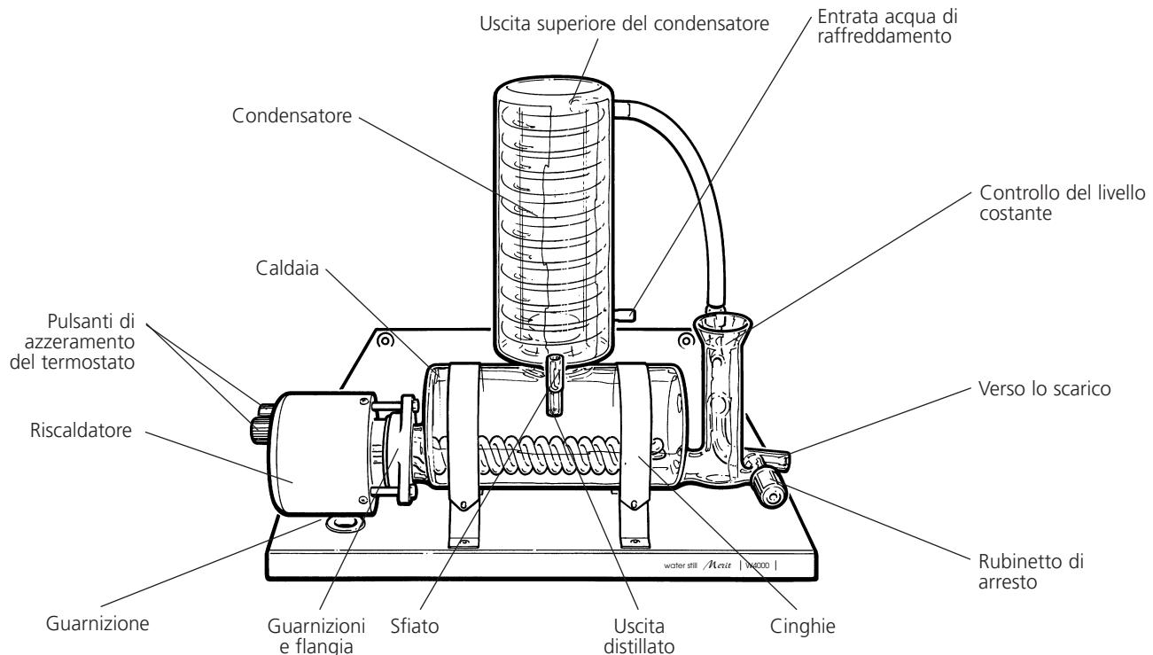
Figura 1 Montaggio generale
