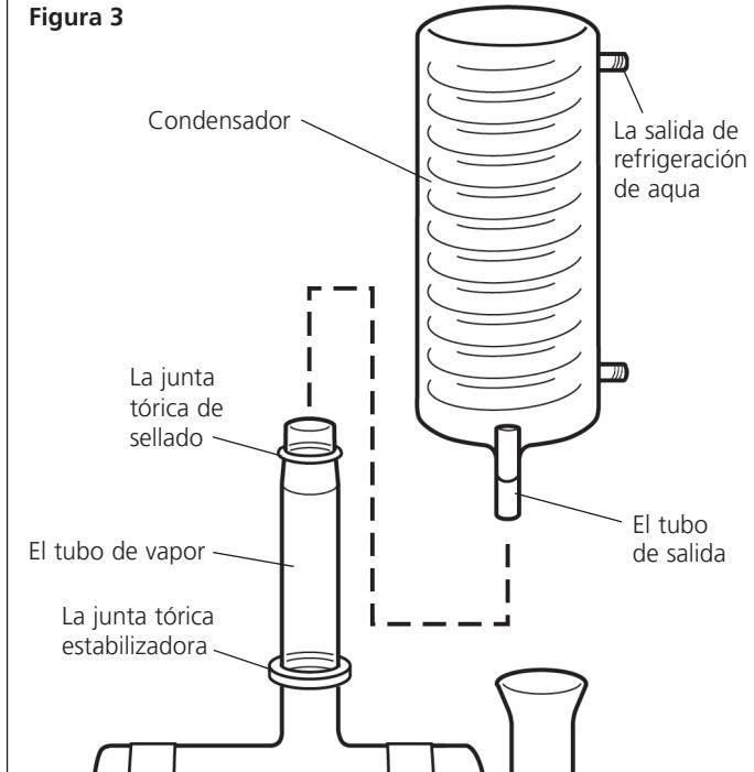
6. En el kit de tubos, coja el tubo de plástico de 225 mm de longitud y 8 mm de diámetro que tiene las uniones roscadas en los dos extremos. Según la Figura 1, rosque un extremo del tubo en la salida superior del condensador, y el otro extremo en la rosca de vidrio del control de nivel constante. Si el alambique está montado correctamente, el tubo debe llegar cómodamente, sin tensiones.
